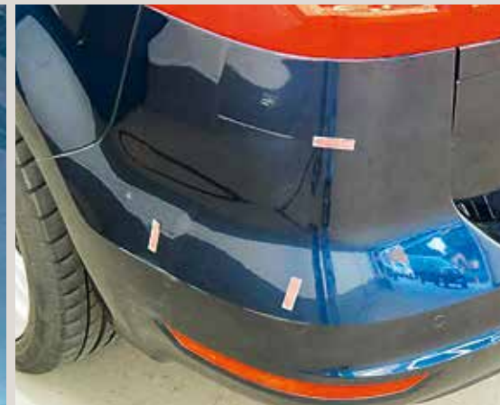
Lackschäden am Stoßfänger
