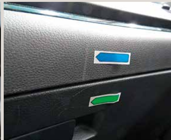
Geringfügige Beschädigung der Kunststoffverkleidung
