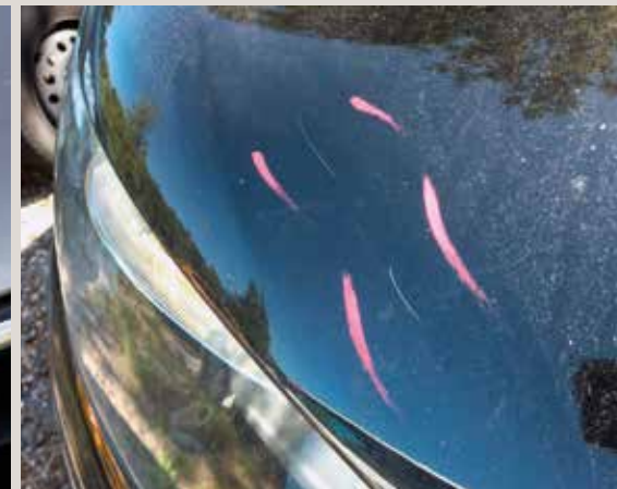
Beschädigung des Basislacks
