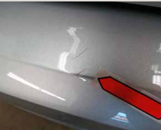
Kratzer in der Lackoberfläche
