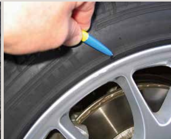
Leichte Materialabtragung an der Scheuerleiste
