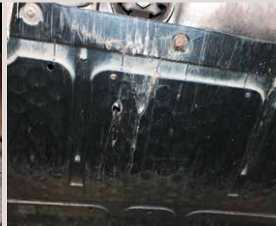
Beschädigung der Unterbodenverkleidung
